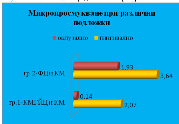
Фигура №23. Микропросмукване при два цимента за подложки
