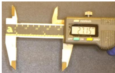
Фиг. 4. Електронен шублер
