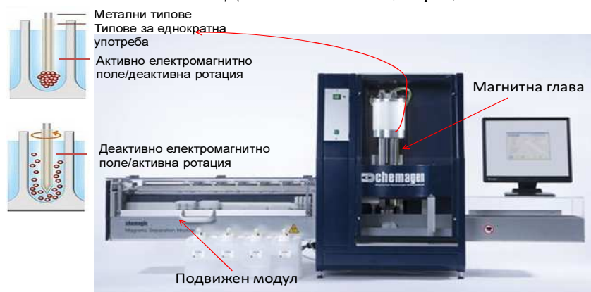
Фигура 3.1. Общ вид и принцип действието на полуавтоматизираната система Chemagic Magnetic Separation Module station I (Chemagen) за изолиране на ДНК от венозна кръв
