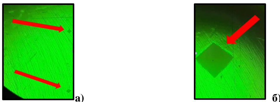
Фиг. 27. Изображение на отпечатъците, които оставя индентора при едно и също увеличение (x40): а) недеминерализирана повърхност; б) деминерализирана повърхност.
