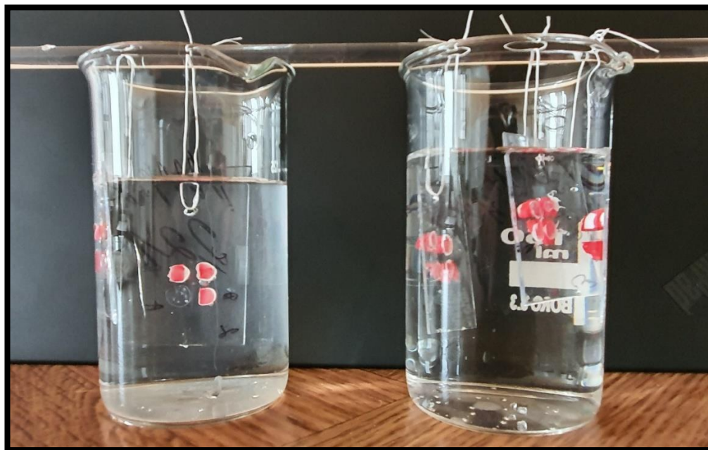
Фиг. 17. 1. Схема на експерименталната постановка: А. Стъклена поставка, върху която са фиксирани образците; Б. Електромагнитна бъркалка, чрез която се осигурява разбъркването на разтвора на изкуствена слюнка три пъти дневно; В. Бехерови чаши, в които са потопени плексигласовите пластини с емайловите образци в 100 ml разтвор на изкуствена слюнка; 2. Снимка на експерименталната постановка.
