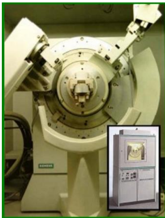
Фиг. 8. Рентгено-структурен дифрактометър D500 ( Siemens, Germany ).
