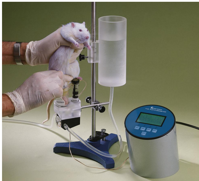
Фиг. 7. Plethysmometer. Обемът на лапата (в ml) се отчита на базата на водоизместимостта.
