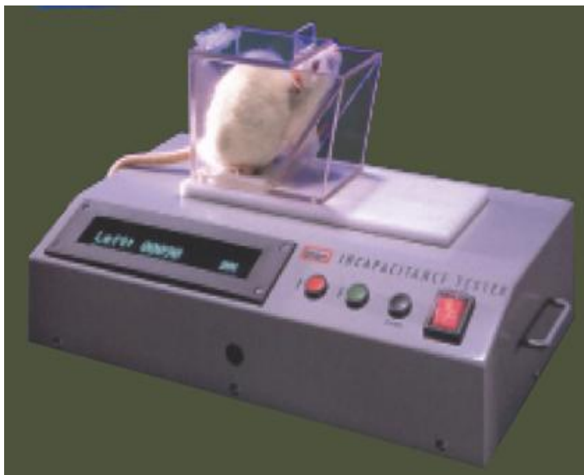
Фиг. 1. Incapacitance test . Животното е поставено така, че да пренася цялата тежест на тялото върху задните крайници. Разпределението на тежестта корелира със силата на болката, която изпитва.
