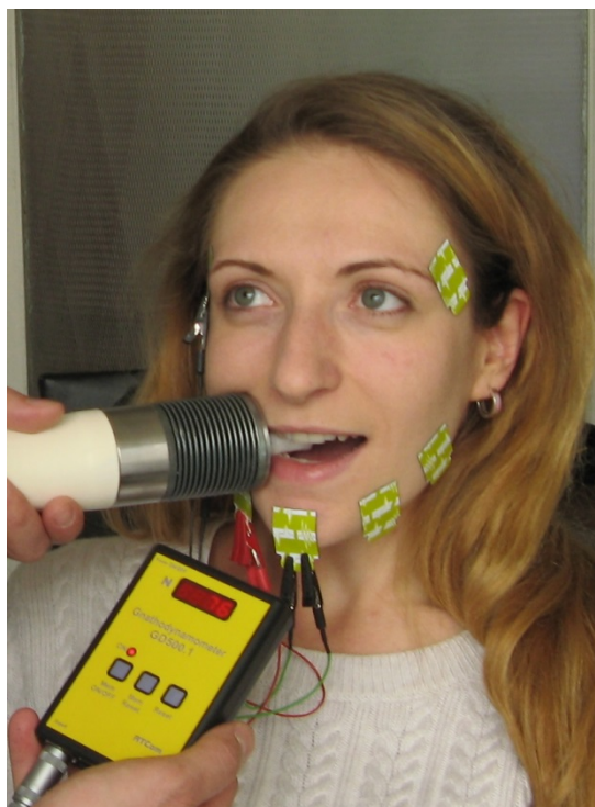
Фиг. 14 . Симултанно отчитане на силата на захапката с помощта на гнатодинамометър и на електромиографска активност.
