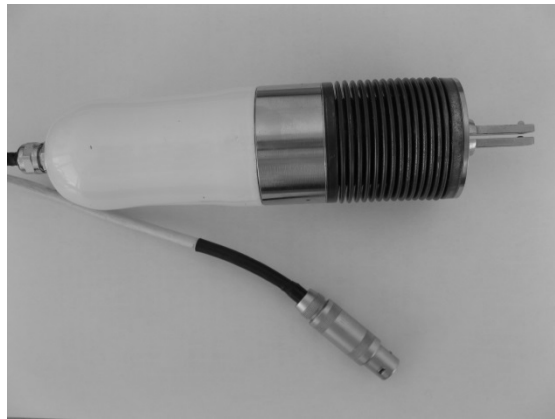
Фиг.12. Тензометричен силомерен модул 500 N
