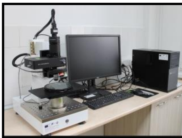
Фиг. 3. 3D оптичен профилометър Zeta-20
