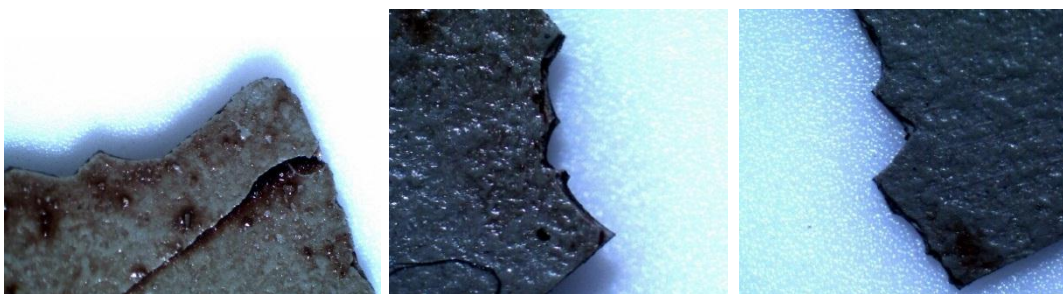
Снимки №№70А, Б и В - Стереомикроскопски изображения на намерени при аутопсия люспи автомобилна боя, с проста еднопластова нееластична структура и неравна повърхност. Оригинално увеличение 4х.
