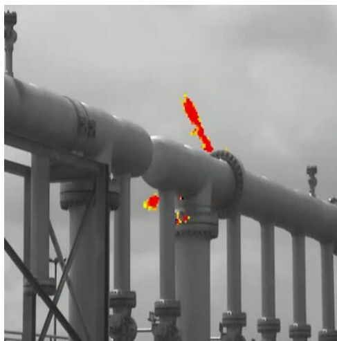
Фиг. 8. Детекция на изтичане на газ с термокамера
