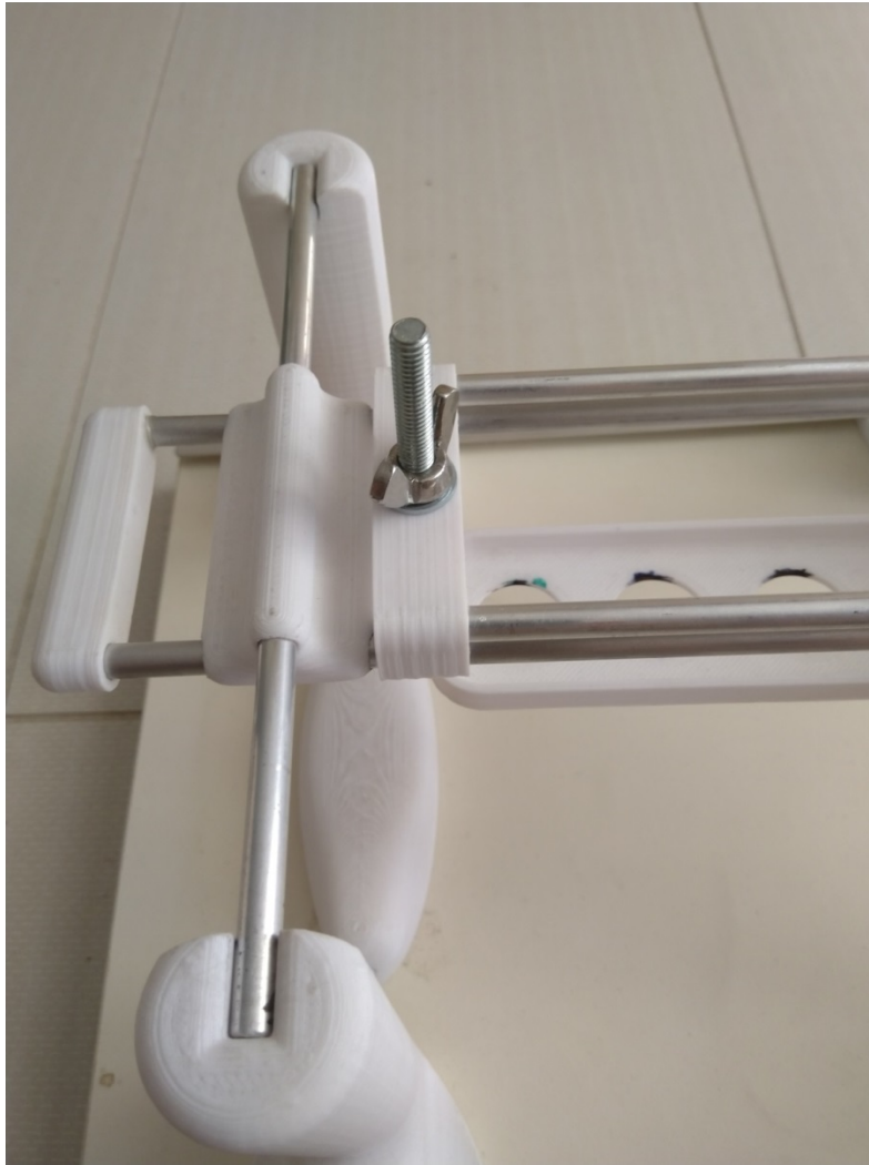
Фиг. 46. Механизъм за ажустиране на подвижната част на стойката към предмишницата на пациента
