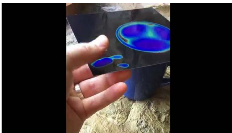
Фиг. 3. Снимка на поставена плака върху чаша с топла вода
