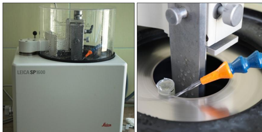
Фиг. 11. Срязване на образците апарата SP 1600
