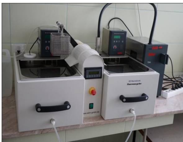
Фиг.10. Апарат за термоциклиране на зъбните образци
