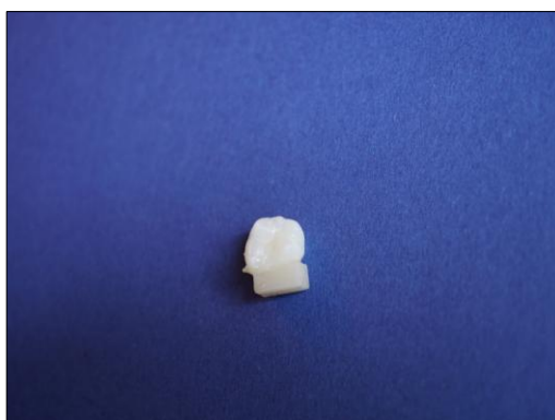
Фиг.9. Образец на зъб, свързан с адхезивен цимент с композитно блокче.
