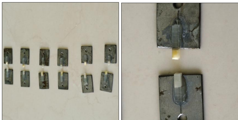
Фиг. 14. Разлепени образци след микротест на якост на опън.
