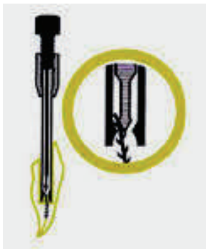
Фиг. 4: Схема на захващания механизъм на Masserann kit (изображение от продуктивния каталог)
