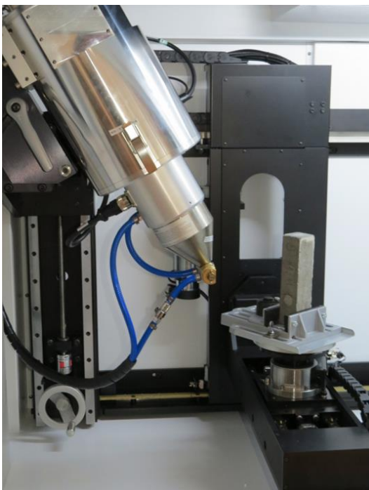
Фигура № 19. Индустриална рентгенова томографска система Nikon XT H 225
