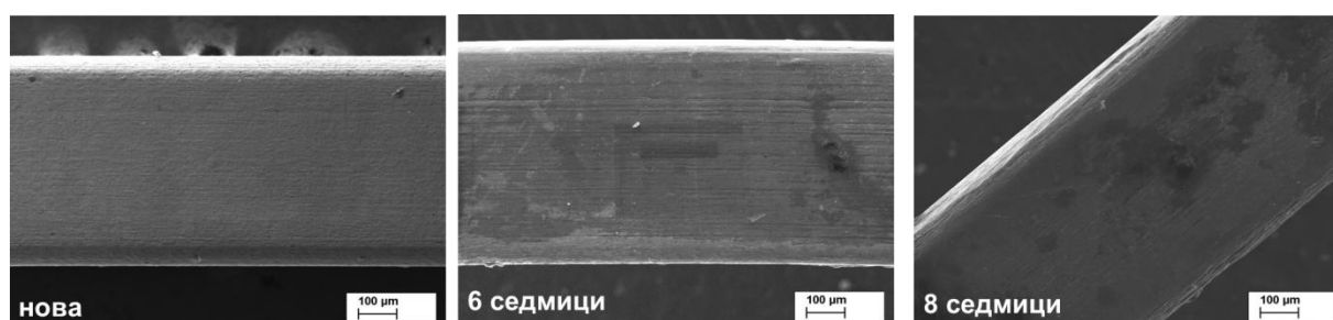
Фигура 49: СЕМ снимки на повърхността на мед-никел-титан ортодонтички дъги с правоъгълно сечение.
