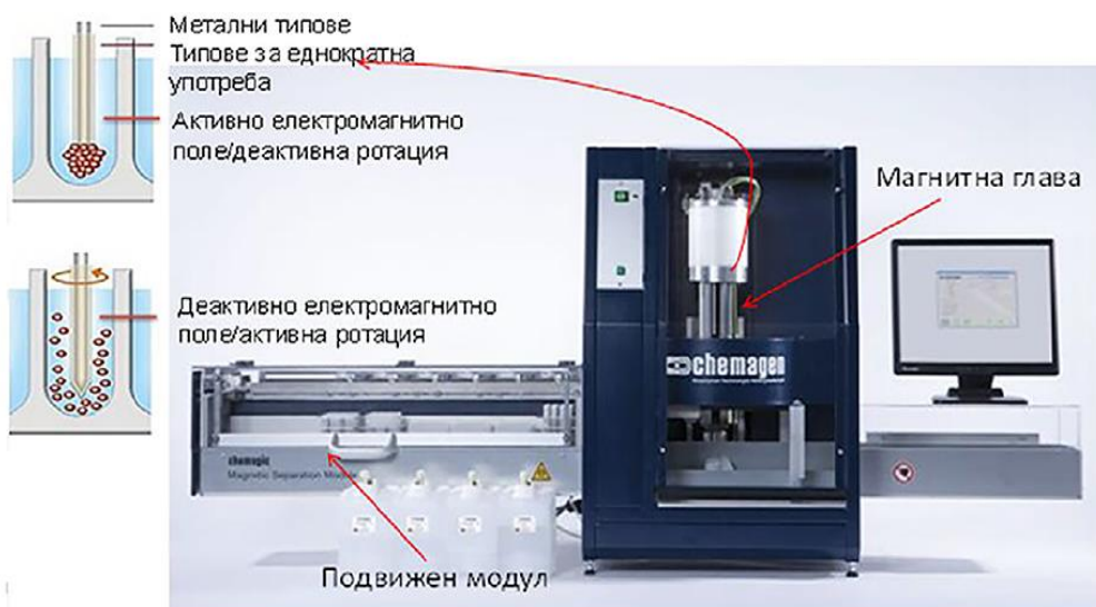
Фигура 8. Chemagen® magnetic separation station (PerkinElmer) система за изолиране на ДНК.
