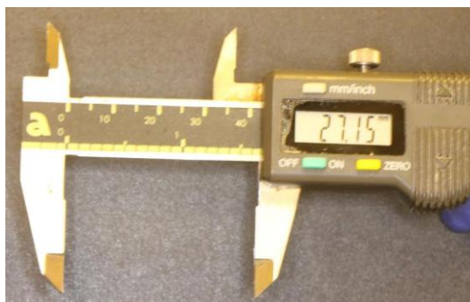
Фиг. 30. Електронен шублер
