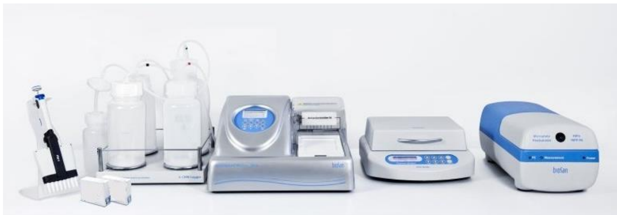
Фигура 6. Спектрофотометър Biosan SIA за определяне на токсини.
