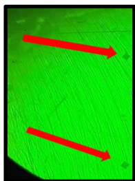
Фиг. 21. Изображение на отпечатъците, които оставя индентора при едно и също увеличение (x40): а) недеминерализирана повърхност; б) деминерализирана повърхност.
