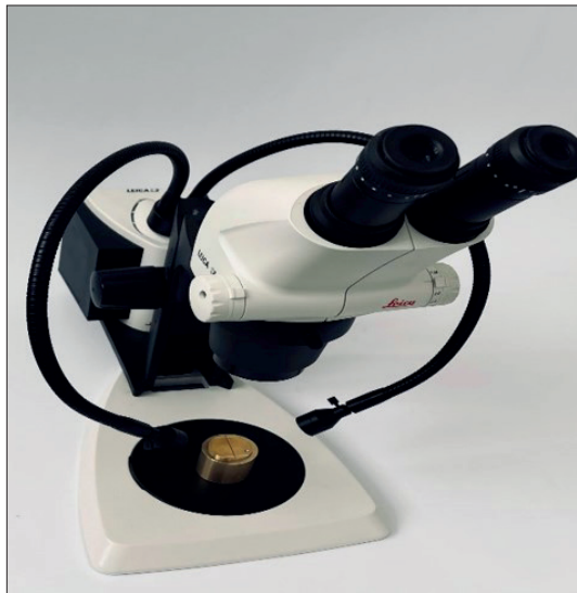
Фиг. 31. Контролът на повърхността на цилиндричната матрица
