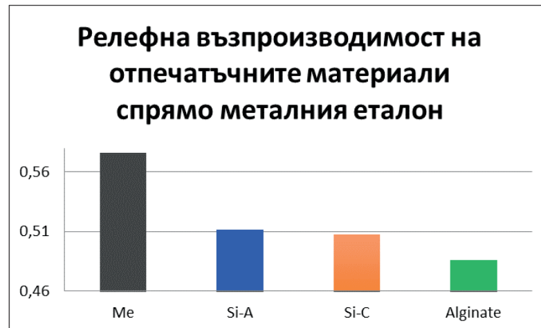
Фиг. 74. Релефна възпроизводимост – метален еталон
