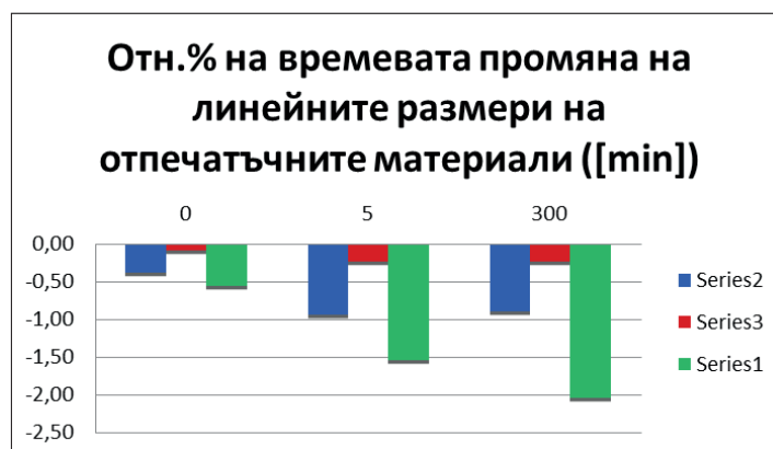
Фиг. 77. Промяна на линеен размер . Относително намаление на разстоянието между маркерите ( спрямо еталона).
