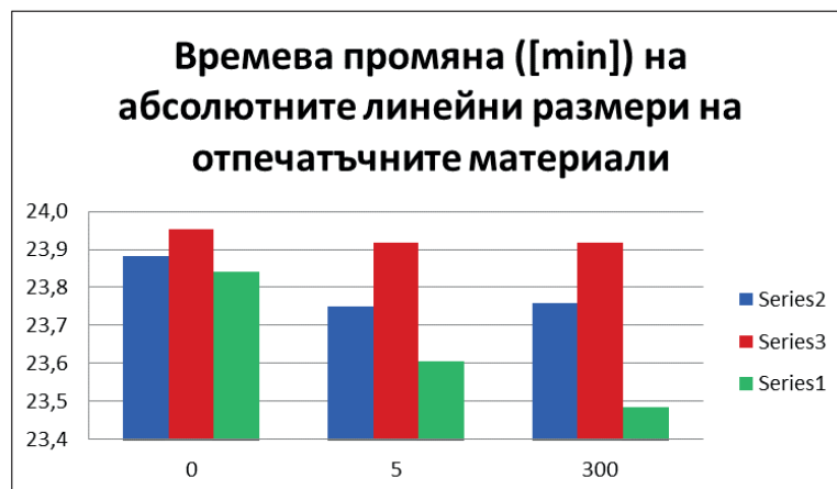
Фиг. 76. Хронологични изменения на абсолютните линейни размери на разстоянието между хребетите на различните ОМ (синьо – Si-A; червено – Si-C; зелено – A)
