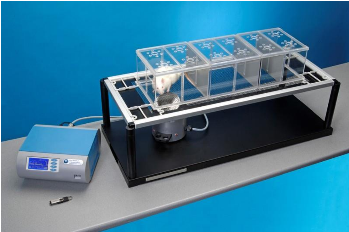
Фиг. 6 Динамичен плантарен естезиометър
