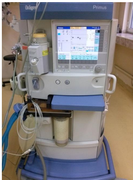
Фигура 4. Основният корпус на анестезиологичен апарат Drager Primus
