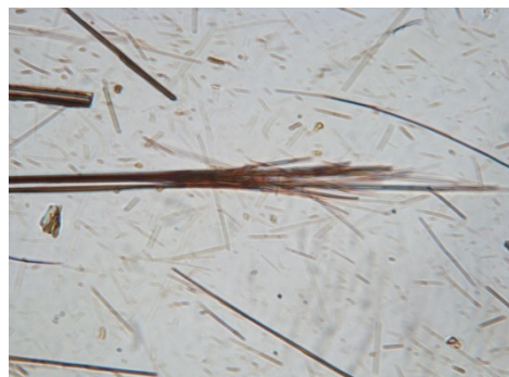
Фиг. 26. Амосит накален при 550°C, наблюдение с поляризатор.
