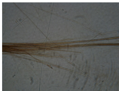
Фиг. 34. Накален при 450°C актинолит при наблюдение с поляризатор.
