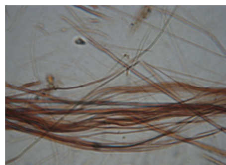
Фиг. 18. Крокидолит налянен при температура 300°C.
