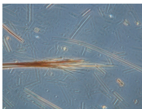
Фиг. 28. Амосит накален при 550°C, наблюдение във фазов контраст.
