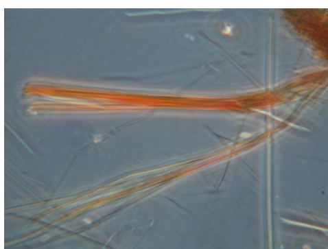
Фиг. 25. Крокидолит накален при 550°C, наблюдение във фазов контраст.
