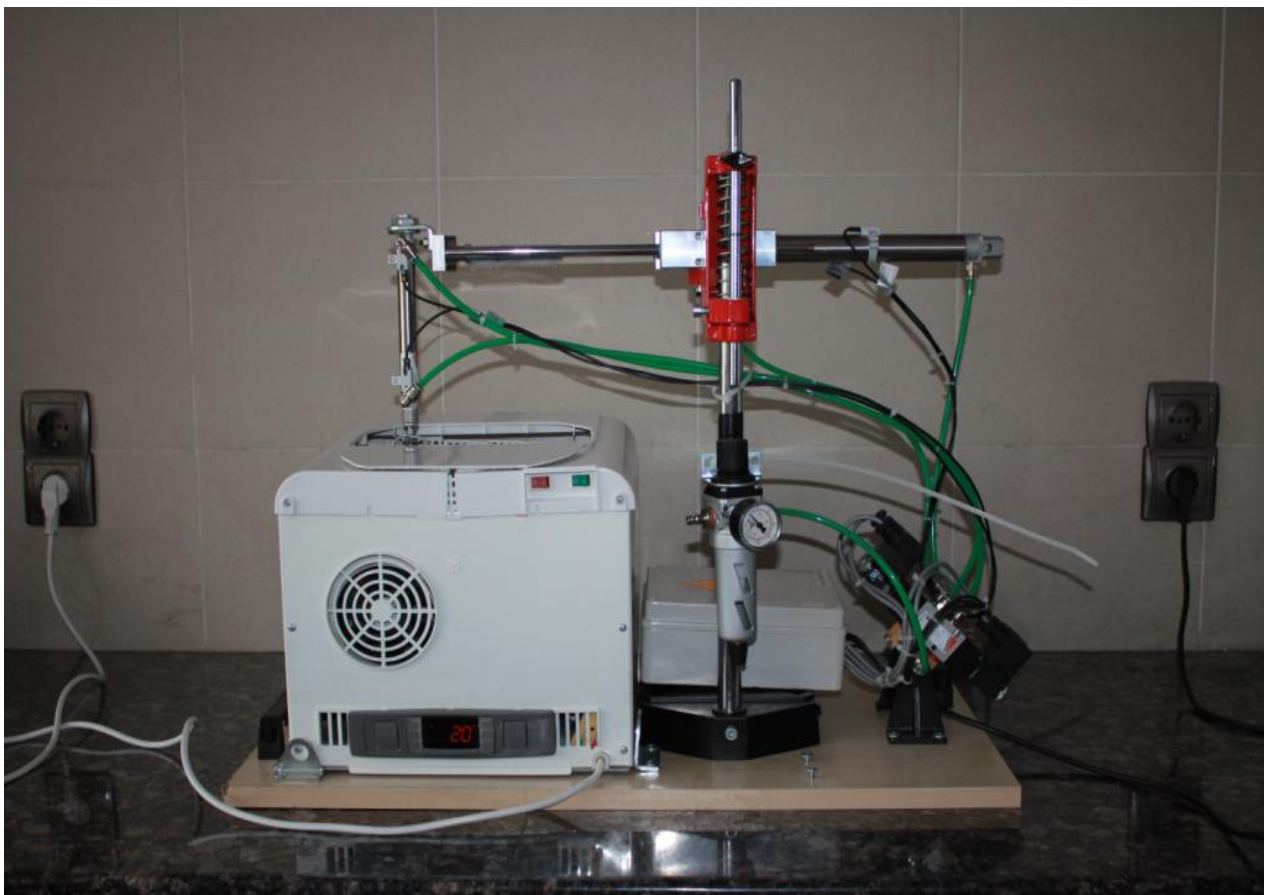
Фигура №1. Апарат за термоциклиране на образци с програмиране на циклите и механично, автоматизирано потапяне (механична ръка)
