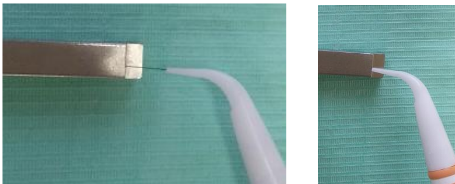
Фиг. 8 Метално блокче за калибриране
