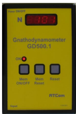
Фиг. 17. Програмируем индикаторен блок GD500.1
