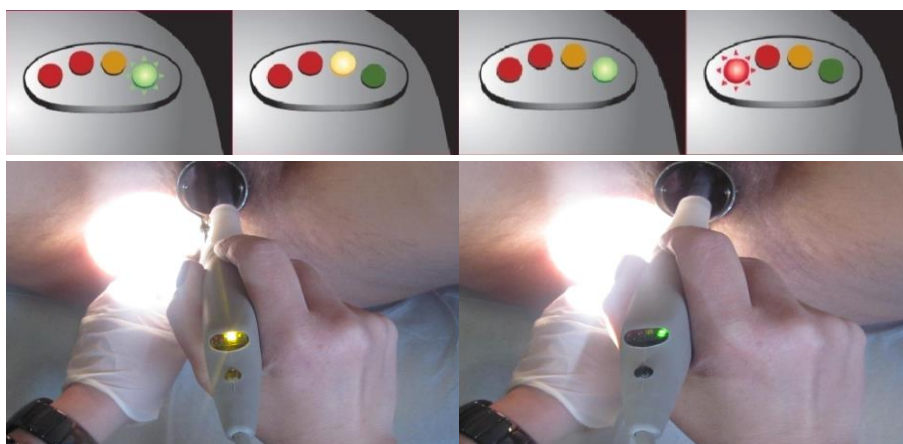
Фиг. 8 Насочване на оператора от светодиодите
