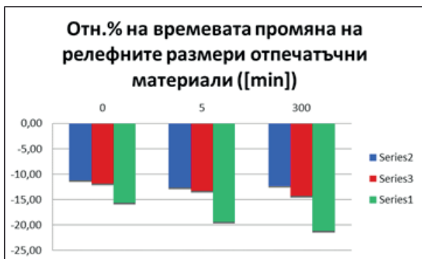
Фиг. 45. Относително намаление на релефните размери (спрямо еталона).
