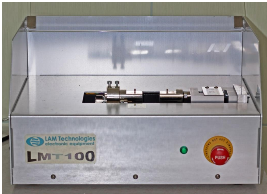
Фиг. 17. Якост изпитваща машина LTM 100.
