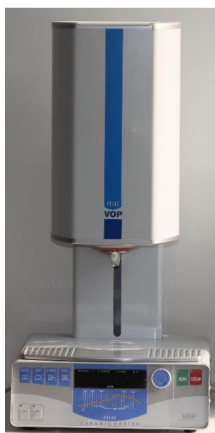
Фиг. 14. Муфелна пещ и пещ за пресоване на керамика
