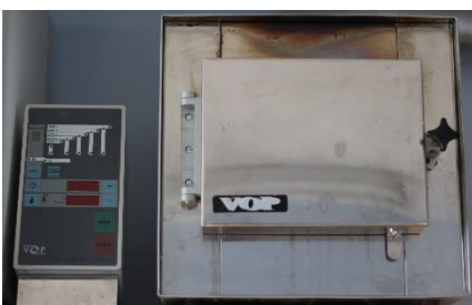
Фиг. 14. Муфелна пещ и пещ за пресоване на керамика
