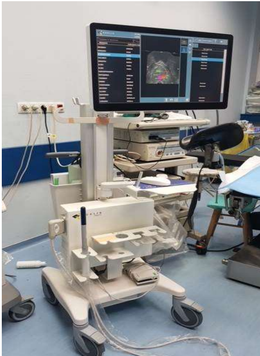
Фигура 16: Система Koelis Trinity, която разполага със патентована система за Organ – Based Tracking Fusion и в комбинация с Elastic Fusion.
