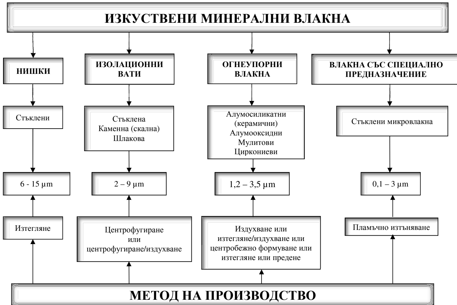
Фиг. 2: Наименования, методи за производство и диаметри на различни видове ИМВ [130].
