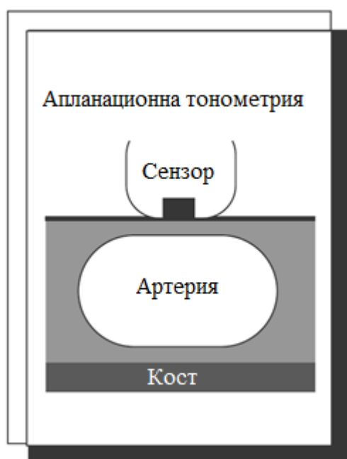
Фиг. 1.9. Принцип на аплатационната тонометрия.
