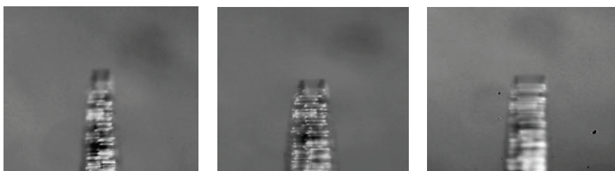
Фиг. 13: Пример за визуално установимо увеличение на амплитудата на вибрация, признак за резонансна съвместимост (увеличение 80x)
