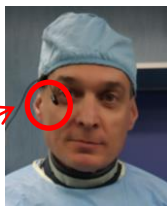
Фигура 6. EDD-30 (Unfors), начин на закрепване.
