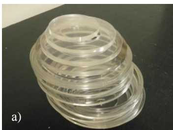
Фигура 18. Фантом за калибриране: цилиндър със сферичен сегмент: а) първи етап от работа за конструиране на фантоми за калибриране; б) изработен фантом на глава.
