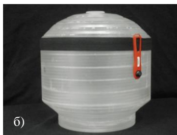
Фигура 18. Фантом за калибриране: цилиндър със сферичен сегмент: а) първи етап от работа за конструиране на фантоми за калибриране; б) изработен фантом на глава.
