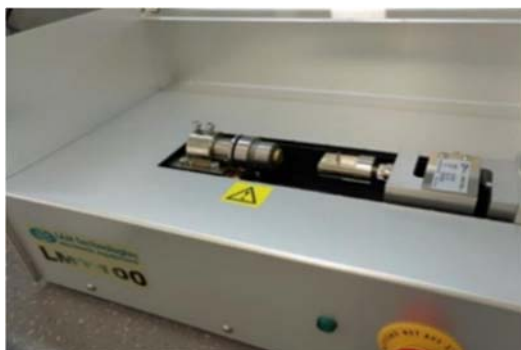
Фиг. 20. Вид на стенда за физикомеханично изпитване по метода push-out
