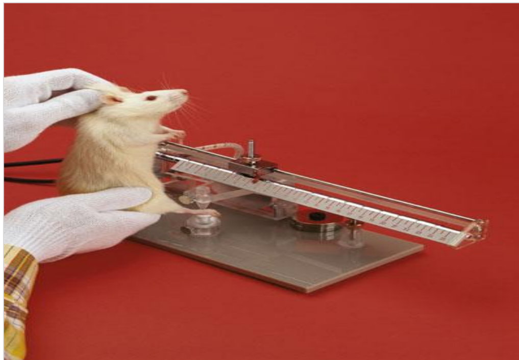
Фиг.12. 2. Hind paw pressure test . Прилага се натиск към дорзалната повърхност на задната лапа, при който настъпва защитна реакция (флексия). Големината на натиска се отчита с \text{g} / \text{cm}^2 .
