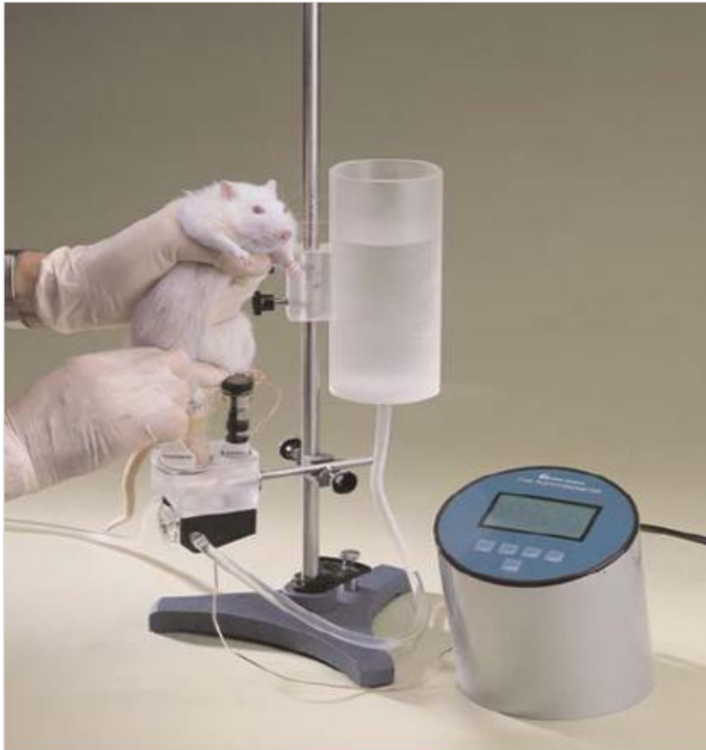
Фиг.12. 3. Plethysmometer (Ugo Basile). Плетизмографията отчита обемът на лапата ( в ml) на базата на възместимостта
