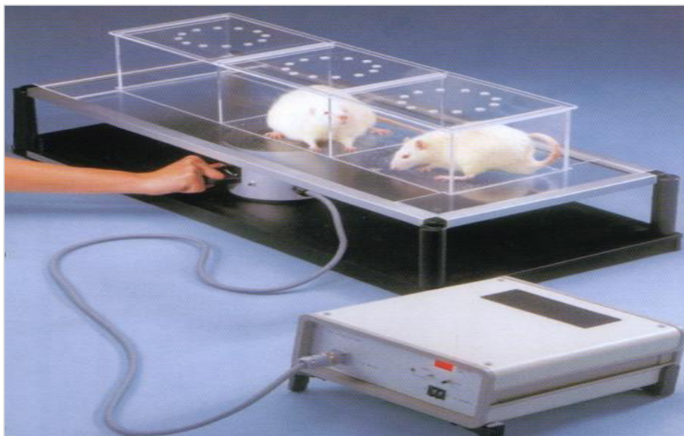
Фиг.4.12. 1. Plantar heat test . Когато животното почувства болка, отдръпва лапата си, датчикът спира да възприема отразената светлина и апаратът регистрира латентното време в секунди
