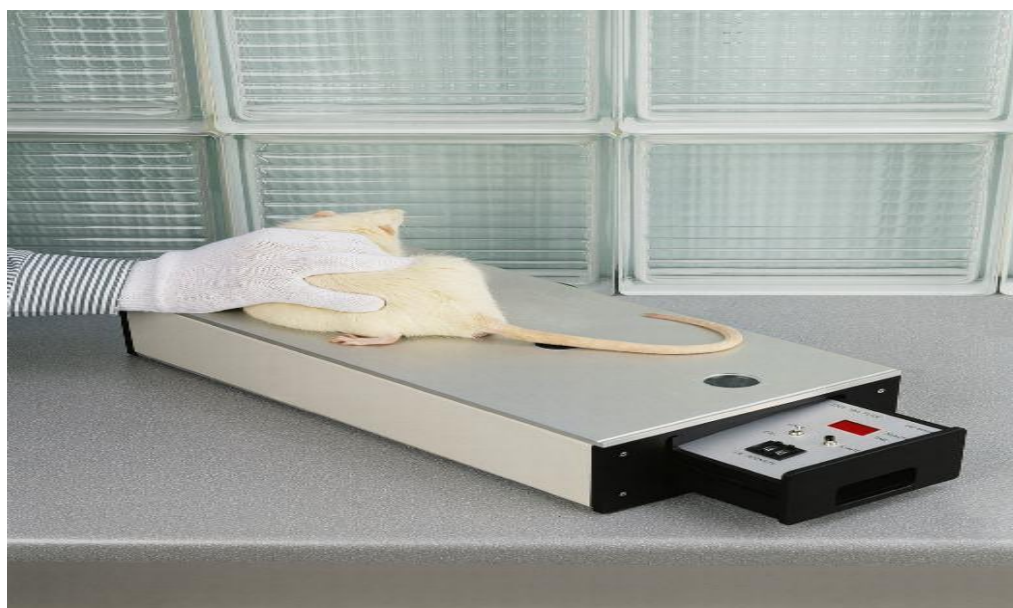
Фиг. 2.1 Radiant heat tail-flick test. Терминалният лъч е фокусиран върху дисталния край на опашката, като времето, за което животното се отдръпва се отчита с таймер
